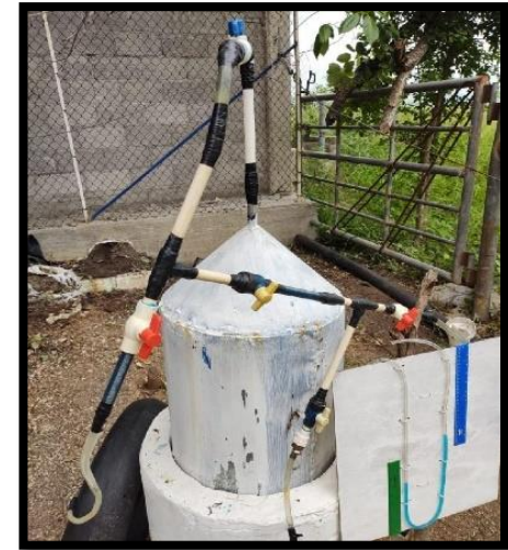
Prototipo biodigestor de campana flotante
